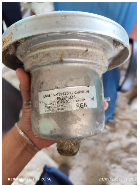
Fotografía 1 Luminaria del túnel de agua retirada
